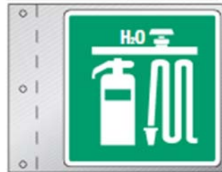
Armoire d'incendie avec vanne d'étage pour gicleurs
