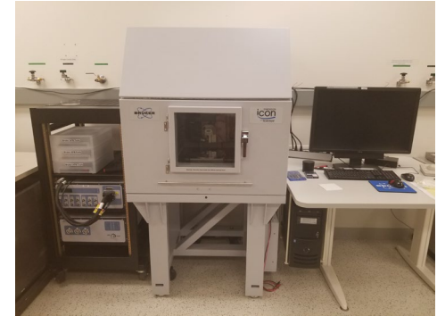
MFA-Bruker – Dimension Icon Microscopie à force atomique pour les échantillons plus gros
