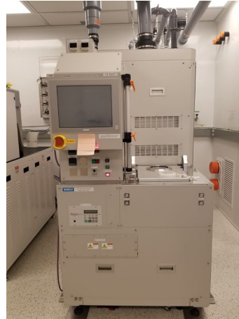
Système de gravure SAMCO RIE-110ip Gravure ionique réactive de plasma relié par couplage inductif (Si and III-V)
