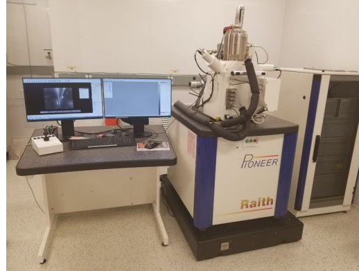
Raith Pioneer SEM + EBL Lithographie à faisceau d'électrons et microscope à balayage d'électrons
