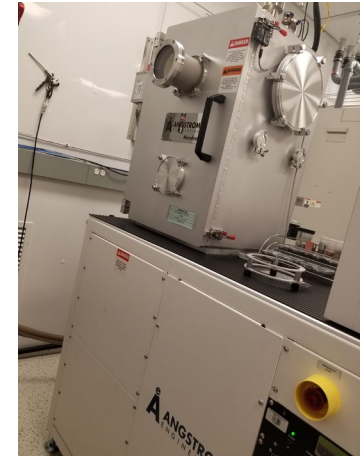
Évaporateur Angstrom Nexdep Évaporation et dépôt chimique en phase vapeur
